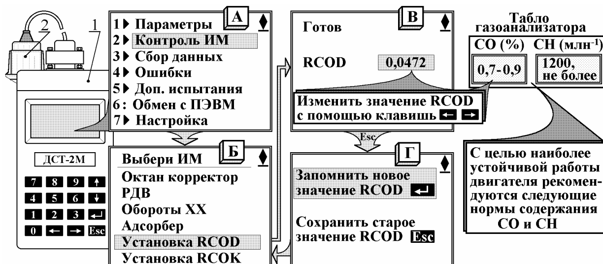
Рис. 6. Регулировка содержания СО и СН на автомобиле с двигателем ЗМЗ-4062, -4052 с помощью диагностического тестера: 1 - диагностический тестер; 2 - диагностическая колодка автомобиля
