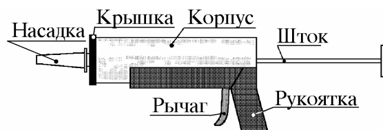
Рис. 15. Приспособление для выдавливания клея из картуша
